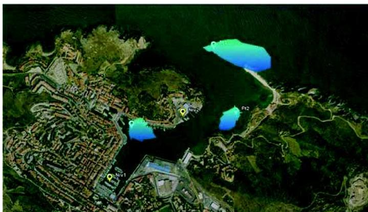
Dans un premier temps, les données de houle du large issues de la bouée de Banyuls, les coefficients de réflexion des ouvrages du port en l'état actuel, ainsi que les paramètres numériques de la houle (caractéristiques du spectre de houle) ont été incrémentés dans le modèle.
